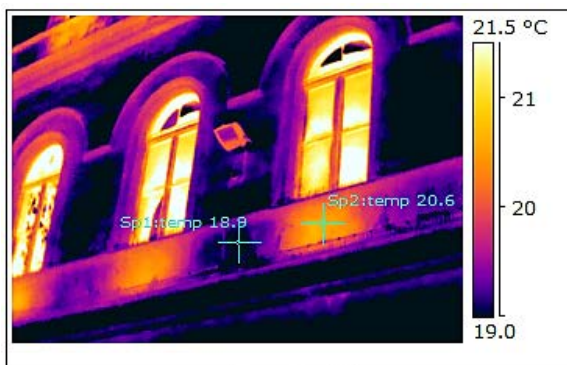
Figura 4.3 – Rilievo termografico del piano primo con esposizione Ovest
